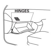
OPEN GLOVE BOX AND DETACH HINGES ON EITHER SIDE THEN REMOVE GLOVE BOX.
