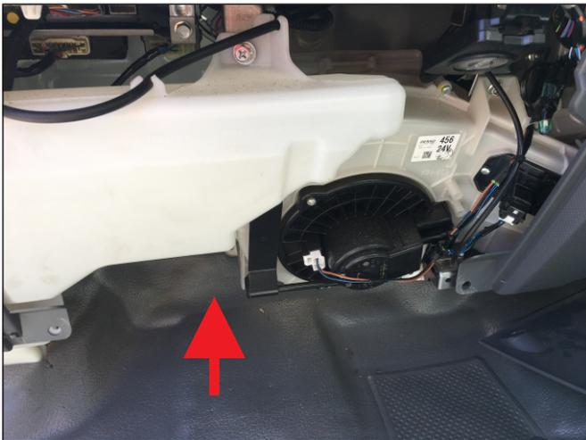
FIG. 8 OEM FILTER LOCATION
