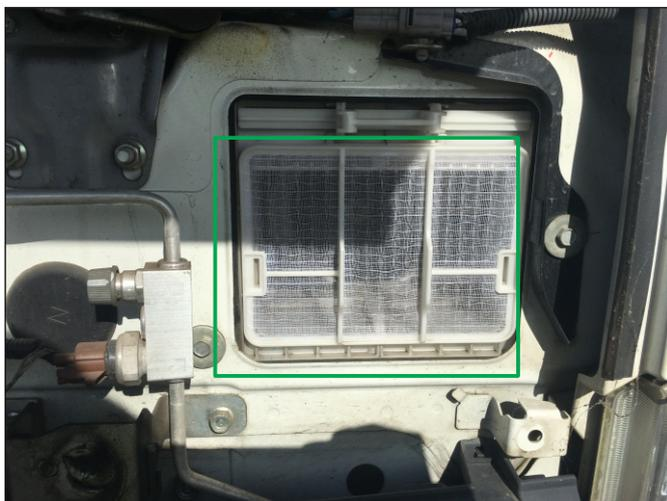
FIG. 13 OEM CABIN FILTER LOCATION
