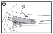
UNDO 3 SCREWS AS SHOWN (SPECIAL TOOL REQUIRED (3)) PULL COVER OUT.
