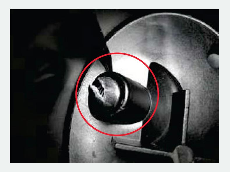
**BROKEN SEAL INSIDE FILTER HOUSING**
